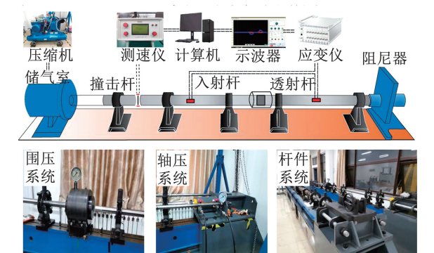
图3 SHPB 实验装置示意
