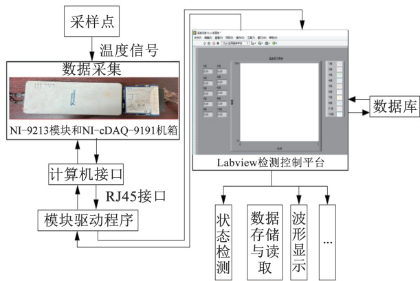
图8 温度采集系统工作原理图
