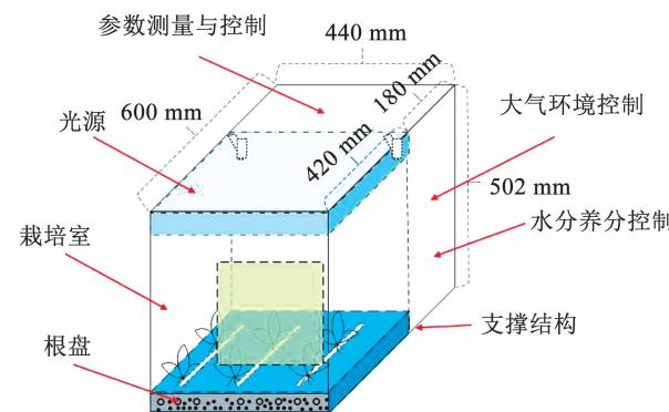
图 1 空间植物栽培装置基本构成
