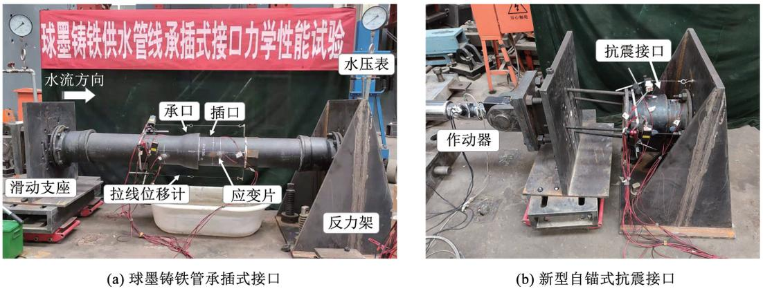
(a) 球墨铸铁管承插式接口
