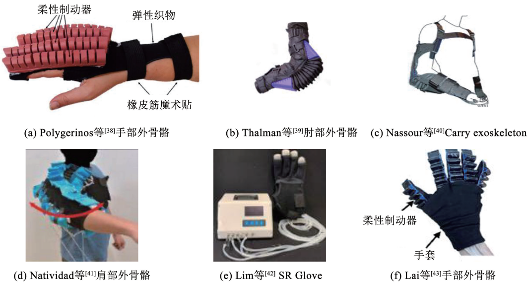
图 6 风琴式气动柔性外骨骼 [38-43]
