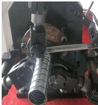
图 18 缠绕锁合轮工作图
