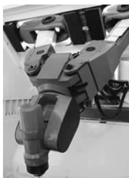
图1 LINKS-EXE700 型加工中心
