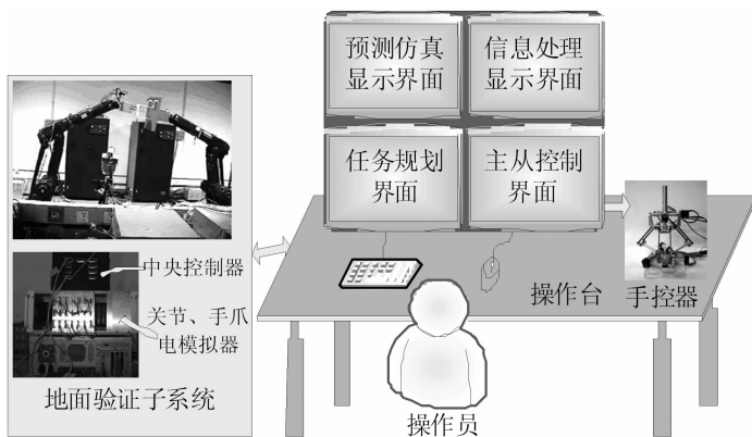
图 3 空间机器人遥操作系统布局图
