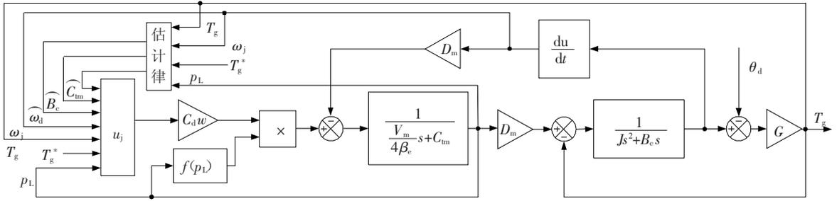
图2 系统结构控制框图
