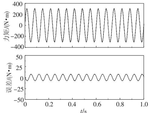
图6 反步控制器控制时的力矩跟踪曲线及跟踪误差
