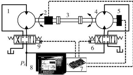
1—加载马达; 2—扭矩传感器; 3—连接轴; 4—承载马达; 5—位置传感器; 6—承载伺服阀; 7—AD/DA卡; 8—计算机; 9—加载伺服阀
