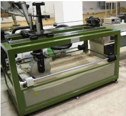
图4 车轮-土壤相互作用测试平台
