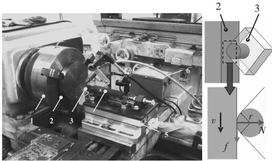
1—三爪卡盘; 2—盘试样; 3—销试样; 4—辅助装置;
