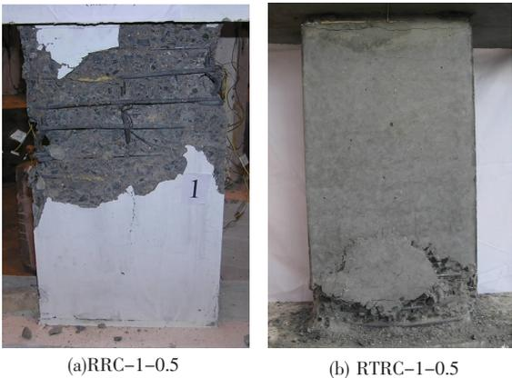
图 4 轴压比为 0.5 超短柱的破坏模式
