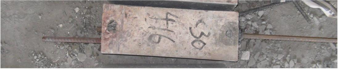
图 5 钢筋混凝土搭接试件完成
