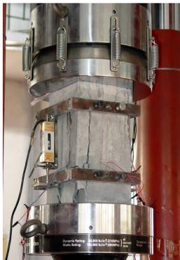
图 1 水泥基灌浆料材性试验
