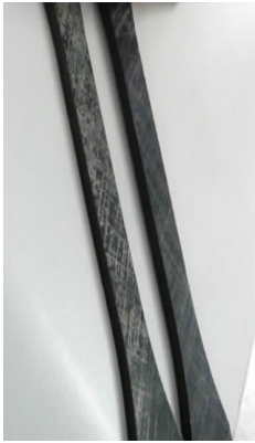
(c) 光老化试件切开后内部与表面颜色对比
