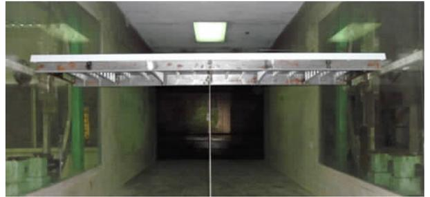
图 8 斜拉桥节段模型
