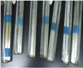
图 3 B 江模拟管道生物膜挂片
