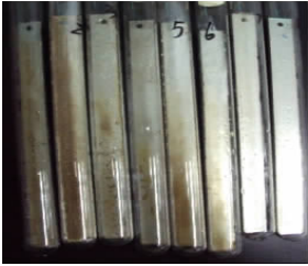
图 2 A 江模拟管道生物膜挂片
