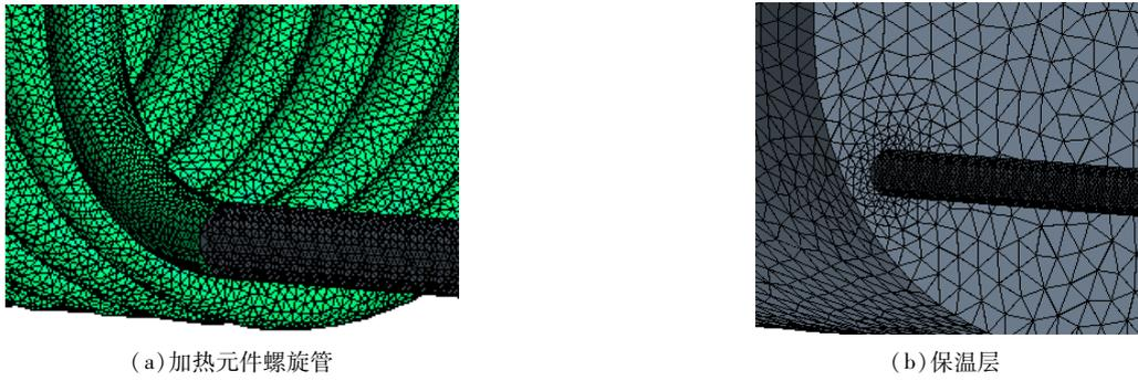
图 2 加热器面网格划分
