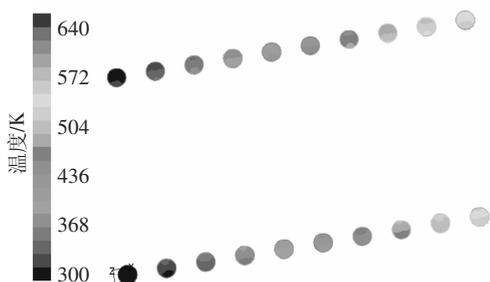
图 9 螺旋管内气流的温度分布图
