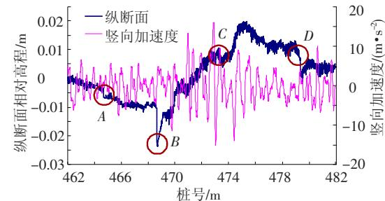
图 1 纵断面相对高程和竖向加速度曲线
