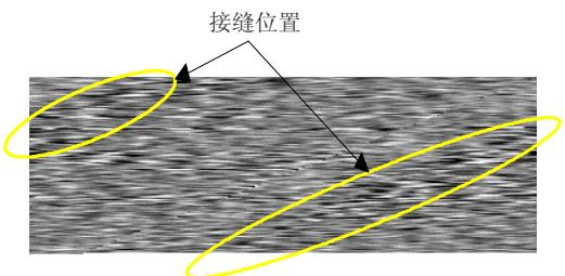
图 3 由加速度-灰度映射图实现接缝定位
