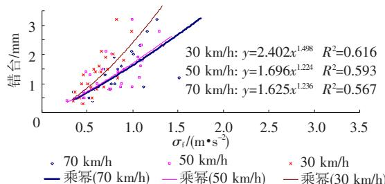
图 8 不同速度下错台与  $a_f$  值的关系
