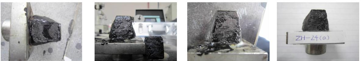
图 4 剪切荷载作用下矿料接触面破坏状态
