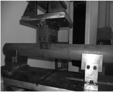
图 13 三点弯曲压力矫直实验模具
