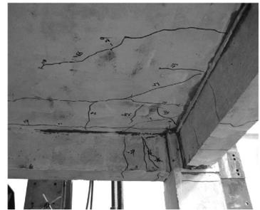
图5 现浇板裂缝
