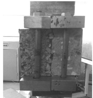
图4 直向剪切试验装置
