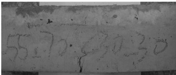
图 4 典型的复合梁抗弯开裂模式
