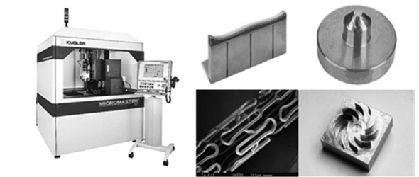
图 16 Kugler 公司的 MICROMASTER 5X 机床及加工示例 [33]
