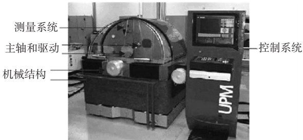
图 14 德国 IPT 开发的三轴超精密机床 [13]
