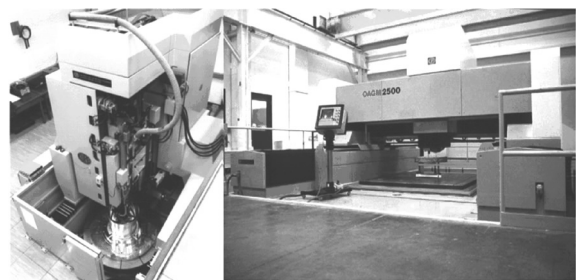
图7 Cranfield 大学研制的大型金刚石车床和 OAGM2500 磨床
