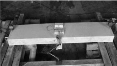
图 9 沙袋跨中加载装置
