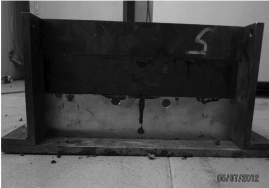
图 2 双层结构车辙试验模具
