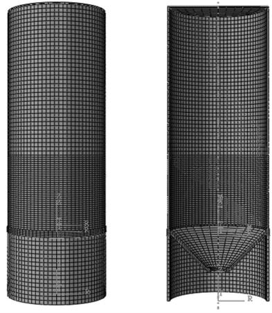
图 2 混凝土网格划分
