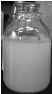
图 4 反硝化脱硫系统含生物硫出水
