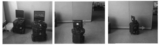
(a)实验使用机器人 (b)机器人由起始点运动 (c)遇到障碍物转弯
