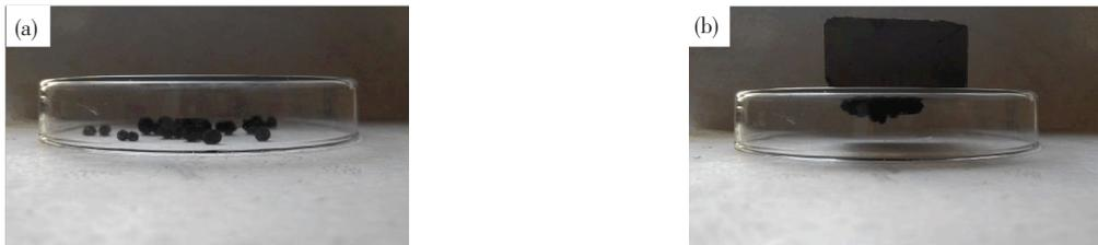
图 3 钢渣粒子电极的磁性定性分析
