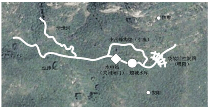
图 2 山西苯胺泄漏事故应急处置技术方案
