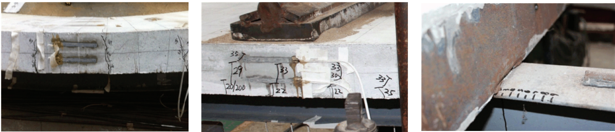
(a) SRCB-120-1-20a 加载点裂缝 (b) SRCB-120-3-20a 加载点裂缝 (c) SRCB-120-3-20a 端部滑移
