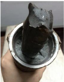
图 4 钢筋断裂破坏
