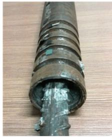
图 5 钢筋拔出破坏
