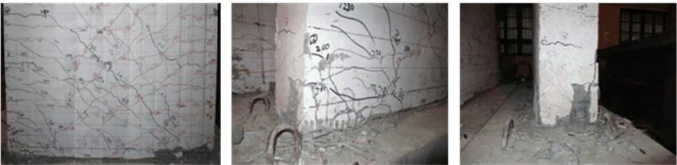
图 7 试件 ZP-1 接缝位置破坏形态
