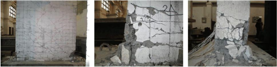
图 6 试件 XJ-1 破坏形态
