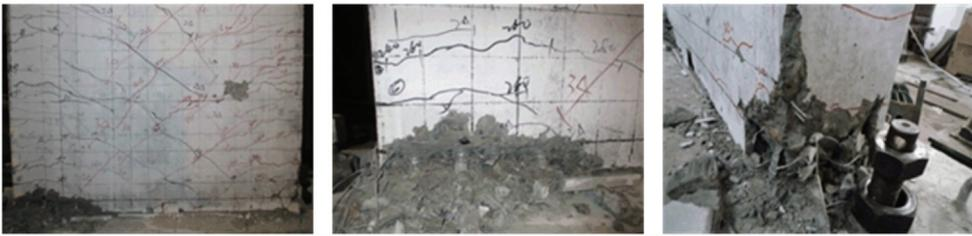
图 8 试件 ZP-2 接缝位置破坏形态
