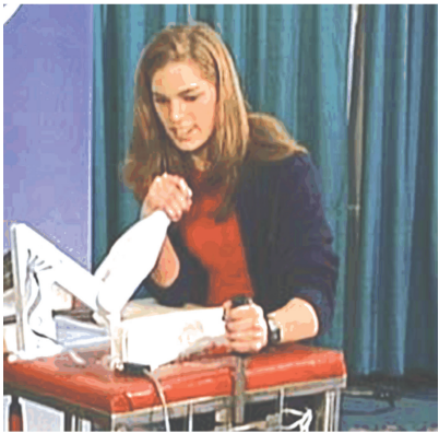
图 3 基于介电弹性体的人工肌肉手臂 [26]
