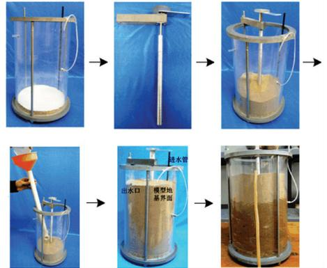
图 3 模型桩的埋设
