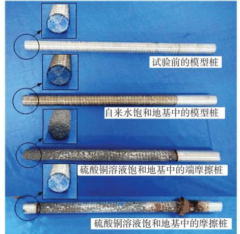
图 10 模型桩腐蚀情况
