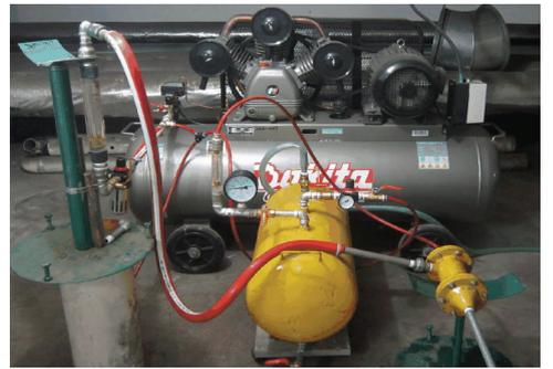
图3 泡沫发生实验装置
