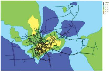
图 5 用水最低时供水管网自由水头分布
