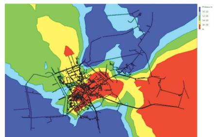
图 4 用水最高时供水管网自由水头分布
