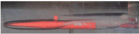
图 9 试验中的超空泡
