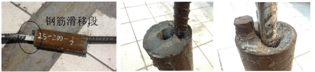
(a) 钢筋滑移 (b) 固定端端部破坏 (c) 加载端端部破坏
