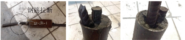
(a) 钢筋拉断 (b) 固定端端部破坏 (c) 加载端端部破坏
