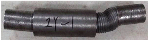
(b) 轴压试件破坏状态
