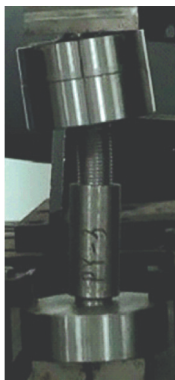
(b) 偏压试件破坏形态
