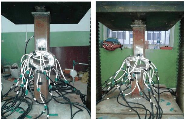
(a) 中心压缩破坏 (b) 梭形偏转破坏
