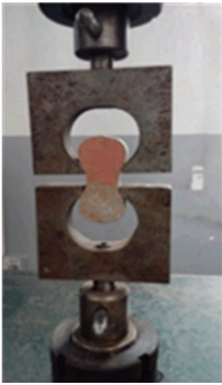
(a) 砂浆抗拉强度试验以及新旧砂浆粘结试验装置
