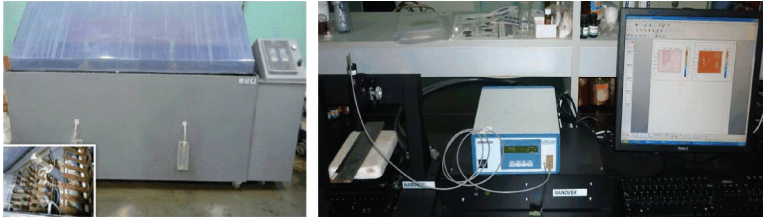
图 1 盐雾箱及 PS50 三维测量仪器 Fig.1 Salt spray box and PS50
