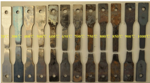
图 10 S460 拉伸试件火灾后的破坏模式
