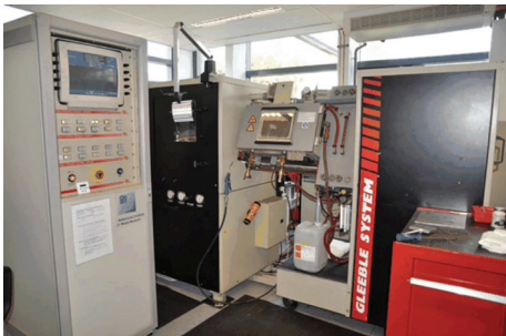
图 2 Gleeble 3800 系统 Fig.2 Gleeble 3800 system
