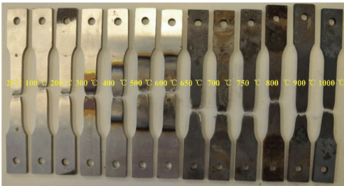
图 11 S690 拉伸试件火灾后的破坏模式
