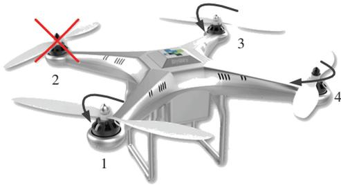
图 2 2 翼发生损坏故障的四旋翼
