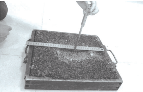
图 6 室内坑槽模型
