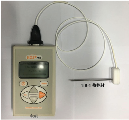
图5 KD2 Pro 热探针仪及 TR-1 热探针
