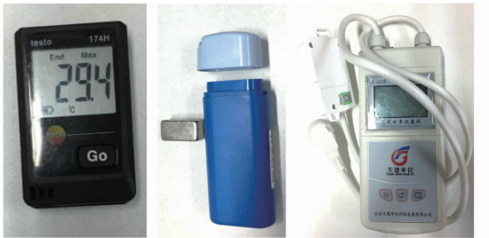
(a) 温湿度自记录仪 (b) 磁开关记录仪 (c) 电功率记录仪
